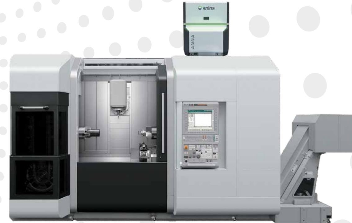
La société suédoise 3nine développe des solutions pour la purification de l'air dans le secteur de l'ingénierie. La technique révolutionnaire qu'elle propose dans ses produits compacts est basée sur la séparation centrifuge permettant un très haut degré de purification. Les séparateurs de brouillard d'huile 3nine ne nécessitent par ailleurs qu'un minimum d'entretien.
